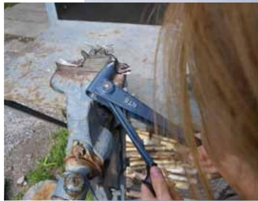
Als nächstes montieren wir den Schwanz an den Körper. Lege alle Teile so zusammen, dass am Schwanzansatz alle vier übereinanderliegen. Spann den Hahn so in den Schraubstock und bohre ein Loch durch alle vier Blechteile. Niete dann den Körper und den Schwanz zusammen.
